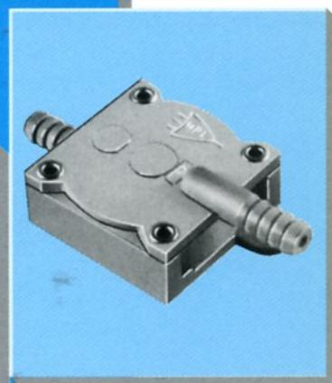
MPL501は、5～10mm水柱という、口で軽く吹き込むくらいの微少の風さえも感知する圧力スイッチです。しかも超小型・軽量で省スペースに向き設定圧も簡単にアジャスト出来ます。価格も従来のものに比べ非常に廉価でOEM使用に最適です。ダイヤフラムタイプのノーマリーオープンスイッチで、ダイヤフラムにより信頼性と寿命が増えました。
